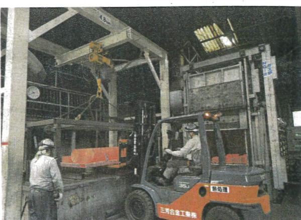
三芳合金工業の朝霞工場(埼玉県新座市)も年内、從来の5tから15t1基に入れ替える。さらに同工場では最大5tを超える製品を流し込む金属製の鋳造金型を導入した。また、炉を1電源で二
