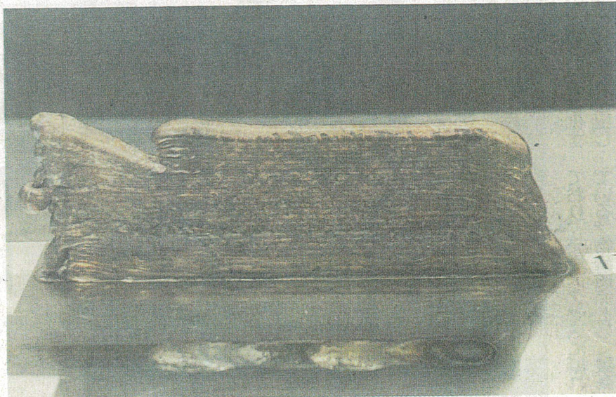
開発研究中のワイヤー式金属3Dプリンター用の高強度銅合金
